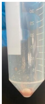
Figura 4. Rimuovere il surnatante, inserire il dispositivo, attendere 10 minuti per l'assorbimento del materiale cellulare all'interno del disk
